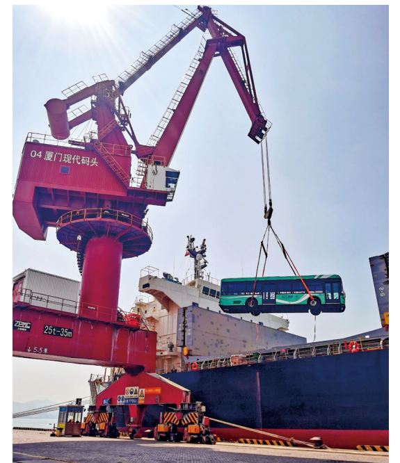
厦门现代码头吊装新能源汽车
